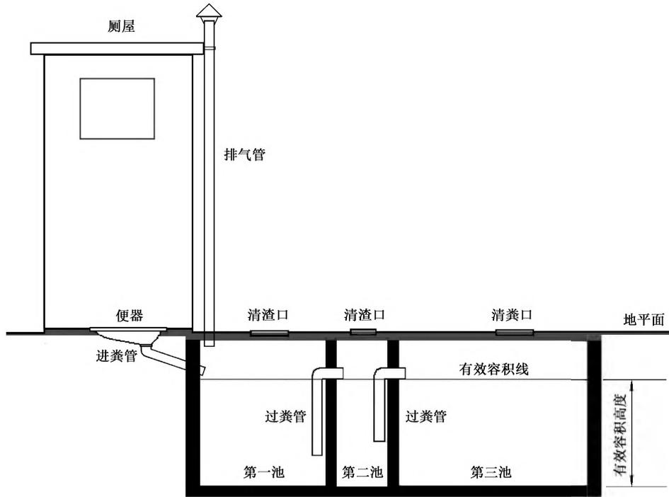
图 A.1 农村三格式户厕构造示意图
