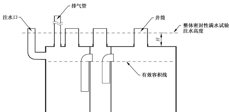
图 B.1 三格化粪池密封试验示意图
